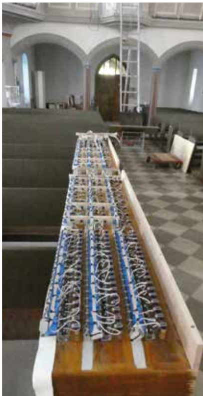
Die Windladen mit der neuen Elektrik: Wippmagnete für die innovative Einzelton-Ansteuerung
